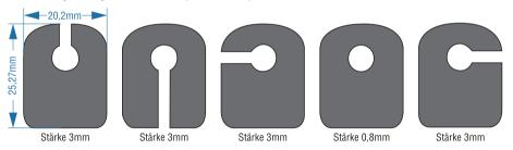
Führen Sie das Kabel in den Innenraum und dichten Sie die Kabeldurchführung zum Innenraum ab, um Wassereinbruch zu Vermeiden.
