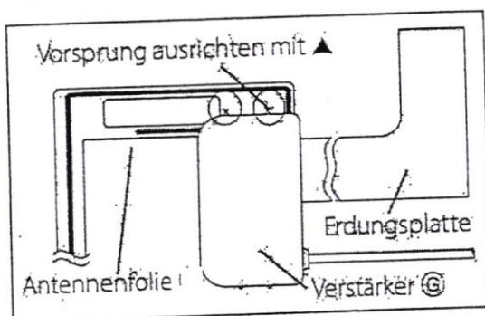
Beim Installieren der Antenne auf der linken Seite
