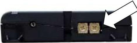
Suchen Sie in der Fahrzeugliste (ab Seite 12) Ihr Fahrzeug. Hinter jedem Fahrzeug steht ein 2-stelliger PIN-Code. Dieser wird über die beiden Drehregler am Steuerteil eingestellt. Nun erkennt das System die CAN-Daten Ihres Fahrzeuges und wertet diese aus.
